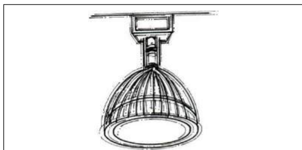
圖10.39 HID高棚燈包括金屬鹵化物燈和高壓鈉燈，具備鋁反射鏡和視覺調控，常見於高天花的商業空間。
