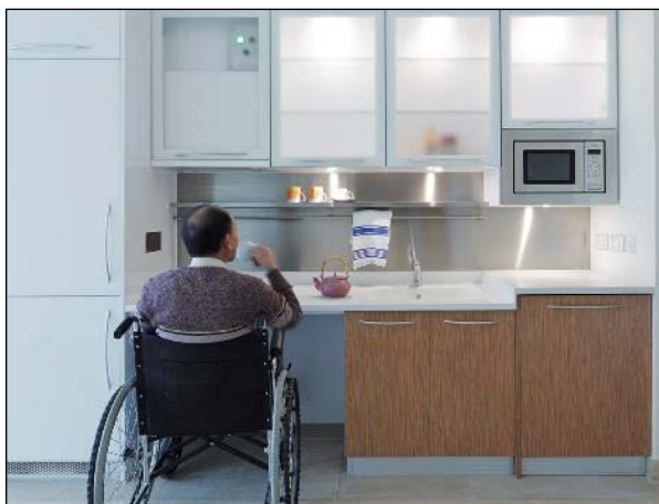
圖 4.60 廚房的檯面高度為0.8米，微波爐及廚櫃高度為1.3米
