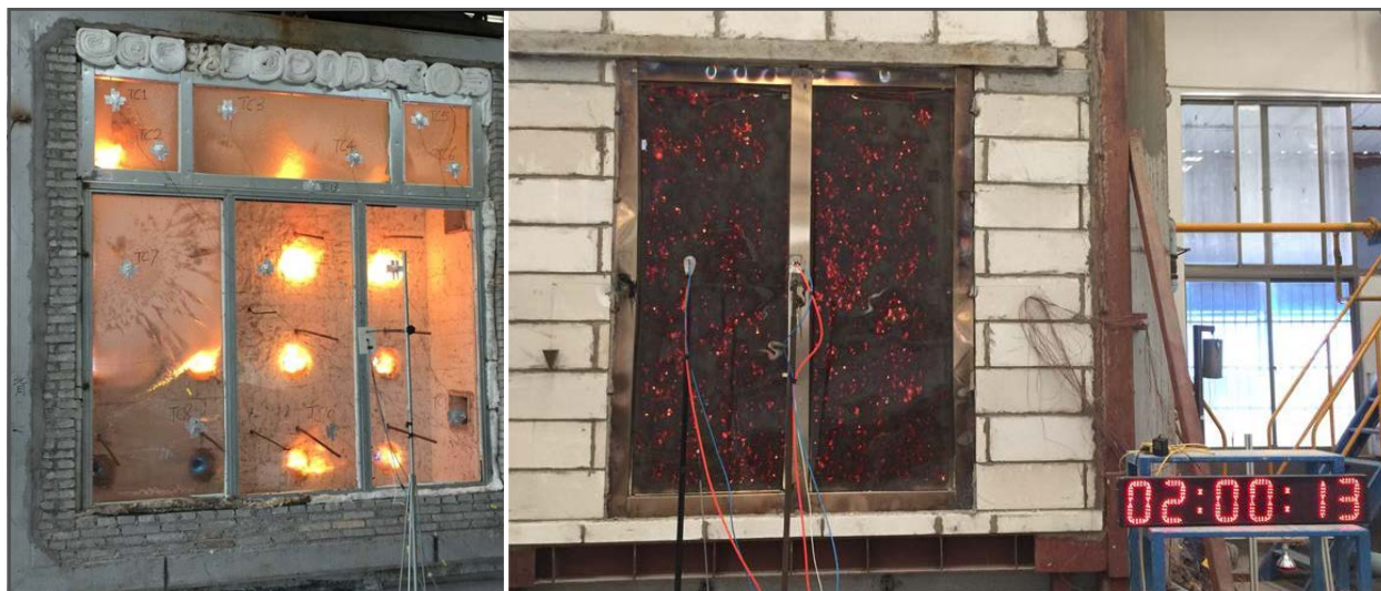
圖3.16 防火門測試 (圖片來源： http://www.firepros.hk/en/Service.aspx )
